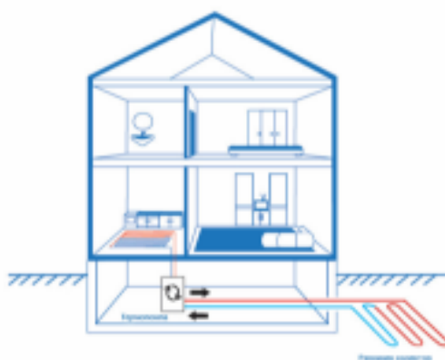
Slika 39. Geotermalna toplinska pumpa s ravnim kolektorom
