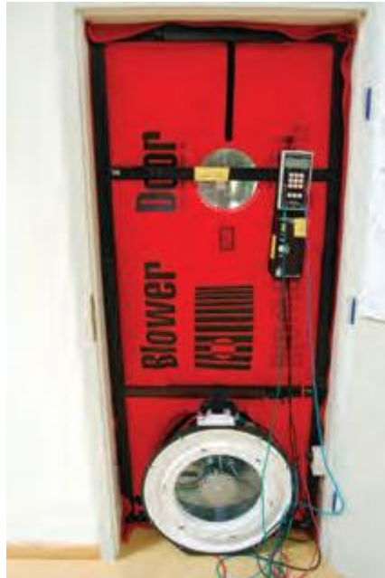
Slika 4. Oprema za provedbu ispitivanja zrakonepropusnosti toplinske ovojnice / Slika: W. Walter
