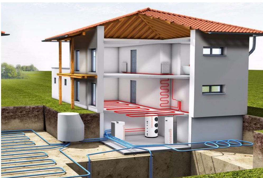
Slika 38 Prikaz sustava grijanja kućanstva sa toplinskom pumpom i
