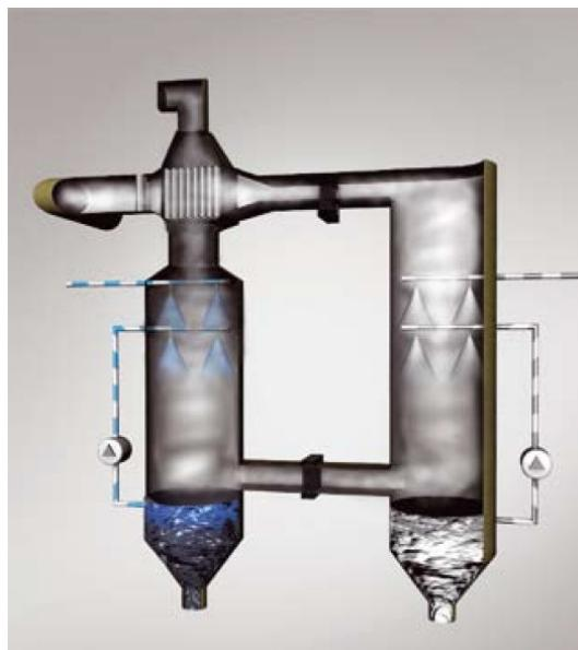
Slika 21: Ispiranje ispušnih plinova vodom (lijevo) i vapnenim mlijekom (desno).
